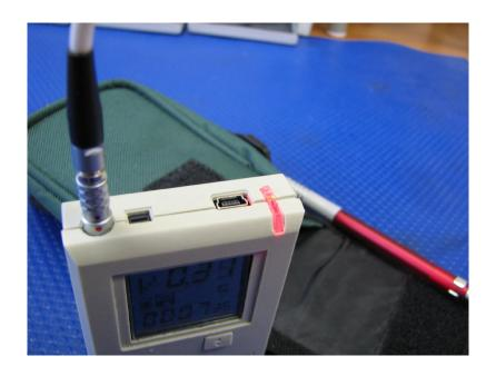
В левой торцевой части находится разъем для подключения датчика к электронной части прибора. При подключении ответной части разъема необходимо обращать внимание на совпадение красных точек.
