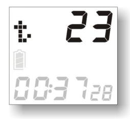
В левом верхнем углу ЖКИ высвечивается символ t, что символизирует температуру, в правом верхнем углу высвечивается численное значение температуры.
