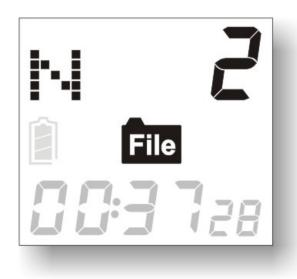
В левом верхнем углу высвечивается символ N, означающий номер. В правом верхнем углу высвечивается цифра (в данном случае 2), символизирующая номер записываемого в память прибора файла (в конкретном случае это означает, что в памяти прибора уже записан один файл и происходит запись второго). В середине ЖКИ слева от индикатора заряда аккумуляторов изображена в стандартном виде компьютерная папка с надписью File, что символизирует о нахождении ЖКИ в режиме отображения файлов.
