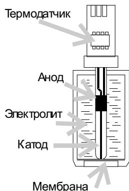
Молекулы кислорода диффундируют сквозь тонкую мембрану в электролит, залитый внутри датчика, и восстанавливаются на катодно-поларизуемом электроде. Восстановление каждой молекулы кислорода сопровождается переносом четырёх электронов
